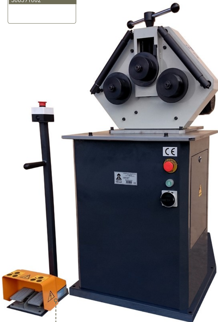
Pedal de maniobra con paro de emergencia
